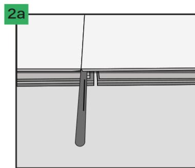
Pour ouvrir facilement le verrou de la dalle, utiliser un dispositif de déverrouillage. Suivez les illustrations suivantes pour le déverrouillage : 2a, 2b et 3.
