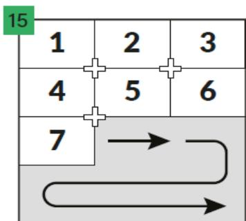
Montez les dalles suivantes, en les posant toujours de gauche à droite, conformément aux flèches figurant sur le dessin.
