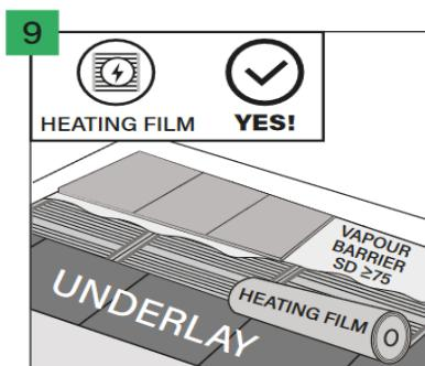
La pose sur le film chauffant est également autorisée à condition qu'une sous-couche appropriée et qu'un film pare-vapeur SD ≥75 soient utilisés sur le film chauffant. L'ensemble du système se compose d'un film pare-vapeur posé directement sur le support, suivi d'une sous-couche appropriée (min. 400 kPa, épaisseur recommandée de la sous-couche : 5 mm), d'un film chauffant, d'un film pare-vapeur et d'un revêtement de sol.
