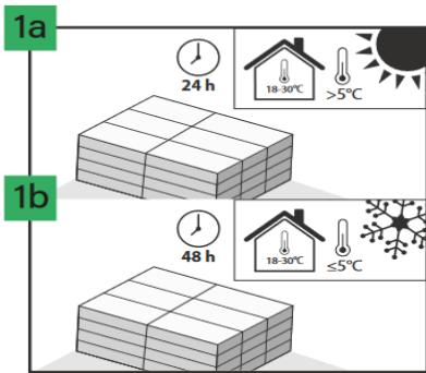
En cas de températures >5°C pendant le transport, le temps d'acclimatation dans une pièce dont la température est comprise entre 18 et 30°C doit être de 24 heures (dans la pièce où les produits seront posés). Toutefois, en cas de températures ≤5°C pendant le transport, le temps d'acclimatation doit être de 48 heures dans une pièce dont la température est comprise entre 18 et 30°C.
