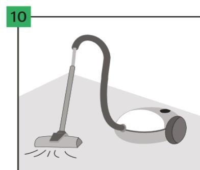
Vérifier que le support soit sec, plat, stable et dépourvu de graisse et de produits chimiques. Les inégalités doivent être grattées et éliminées. Avant la pose, le support doit être soigneusement balayé et aspiré, afin d'éliminer tous les débris. Il est nécessaire de réparer les imperfections plus sévères du support et les fissures importantes.
