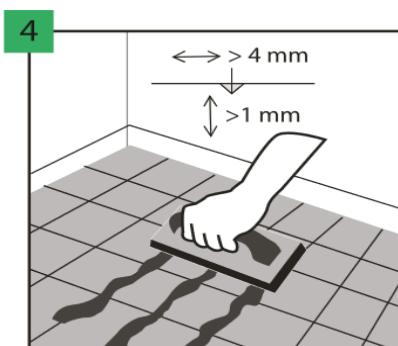
En cas de pose sur un support carrelé, les joints de carrelage présentant un écart supérieur à 4 mm et une profondeur supérieure à 1 mm doivent être remplis à l'aide d'un produit de remplissage durable, tel qu'un mortier de jointolement à base de résine. La pose sur des carreaux avec des joints d'une largeur maximale de 5 mm et d'une profondeur maximale de 1 mm sans égalisation des joints est autorisée, à condition d'utiliser l'apprêt Multiprotec Super Hardlay ou Vinclic Super Solid.
