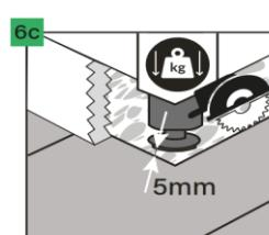
Pour les objets lourds posés au sol (tels que les éléments de cuisine, les îlots de cuisine, les armoires encastrées et autres meubles fixés de manière permanente au mur), laissez des espaces de dilatation de 5 mm autour d'eux.
