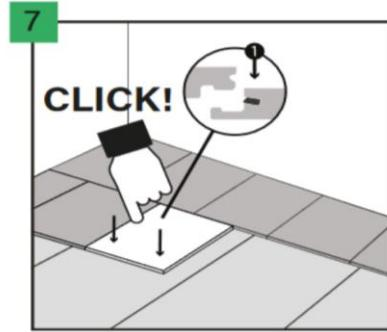
Abaissez ensuite la dalle de manière à ce que le verrou soit fixé sur le petit côté, en appuyant doucement sur la dalle avec les doigts, en partant de l'angle vers le haut. Le verrou du côté court est équipée d'un click spécial qui s'enclenche lorsqu'il est correctement inséré. ATTENTION ! Ne pas utiliser une force excessive ! S'il est difficile d'abaisser la dalle et de la verrouiller, augmenter le jeu du verrou et recommencer l'opération.
