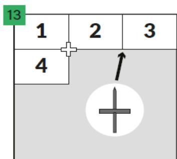
Utilisez un autre croisillon en l'installant dans l'ouverture suivant entre les dalles.
