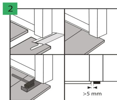
Recouvrir les joints de dilatation le long des murs avec des moulures décoratives, en les installant avec de la colle ou des clips spéciaux. Nous recommandons l'utilisation de moulures Afimax dédiées à une dalle particulière, qui garantissent une excellente correspondance des couleurs et un revêtement résistant aux rayures.
