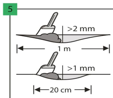
S'assurer que le sol est parfaitement plat. Toutes les irrégularités du support dépassant 1 mm sur une longueur de 20 cm ou 2 mm sur une longueur de 1 m doivent être nivelées.
