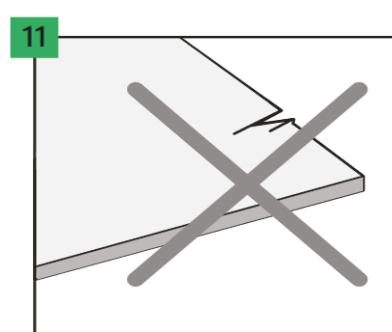
Avant et pendant la pose, toutes les dalles doivent être inspectées dans des conditions d'éclairage optimales. Les dalles défectueuses ne doivent pas être utilisées.
