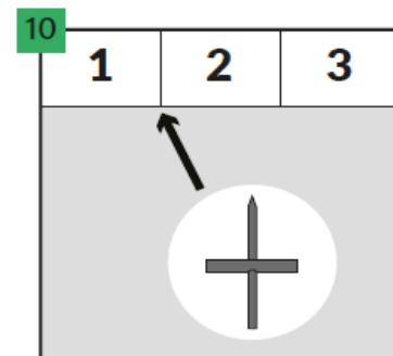
Les croisillons de montage permettent de positionner correctement les dalles et de s'assurer que les dalles sont en contact les unes avec les autres dans les angles sur toute la surface.
