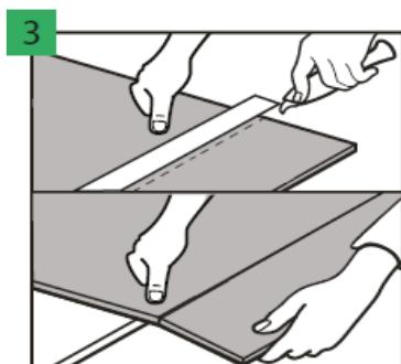
Pour couper les dalles de sol, utiliser un couteau bien aiguisé, incisez la couche supérieure, puis cassez vigoureusement la dalle en la faisant reposer sur le bord. Les dalles de plancher peuvent également être facilement découpés à l'aide d'une scie électrique.
