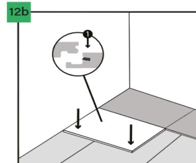
Commencez par raccorder le côté long de la dalle en le faisant glisser dans la rainure de la rangée de dalles précédemment installée. Se déplacer vers l'angle, en laissant un petit espace. Abaissez ensuite la dalle de manière à ce que le croisillon s'enclenche dans l'angle.
