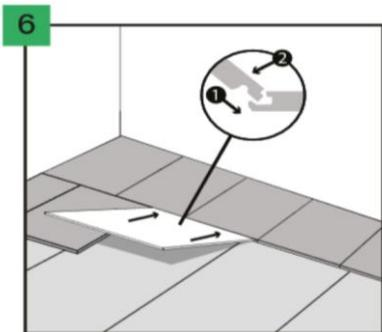
Les dalles sont équipées de verrous d'assemblage sur les côtés courts et longs. Commencez par raccorder le côté long de la dalle en le faisant glisser dans la rainure de la rangée de dalles précédemment installée. Se déplacer vers l'angle, en laissant un petit espace.
