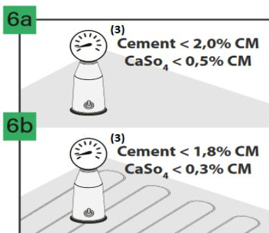
Dans le cas d'une chape en ciment, le taux d'humidité du support doit être inférieur à 2,0 %, et dans le cas d'une chape anhydrite, il doit être inférieur à 0,5 %. Dans le cas d'une pose sur un support avec chauffage au sol, les valeurs mentionnées ci-dessus doivent être respectivement de 1,8 % et 0,3 %.
